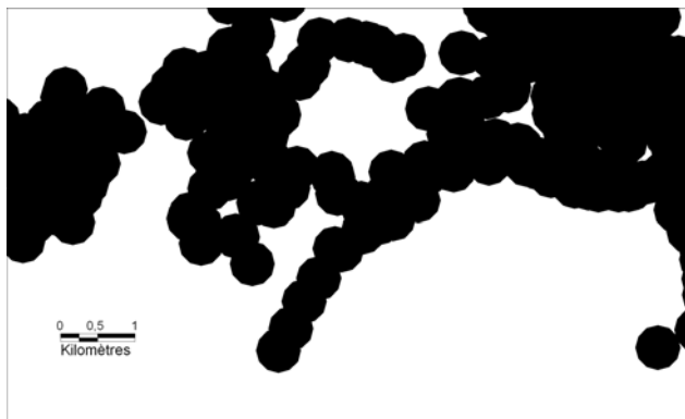
Figure 5 - Application d'un buffer de 300 mètres autour de chaque point d'arrêt.
