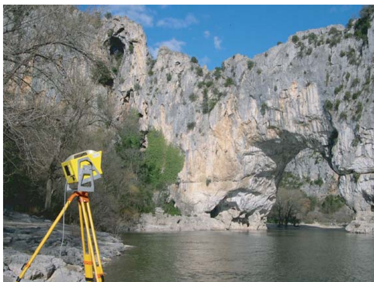
Figure 2 : Scanning du pont d'arc. A partir de la représentation 3D (image de droite), nous voulons analyser sa dynamique d'évolution depuis sa mise en place afin de reconstituer son aspect au fil du temps.
